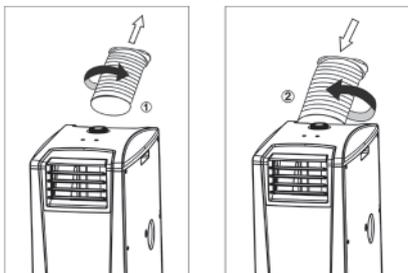
Для включения кондиционера на охлаждение необходимо установить шланг на сторону, на которую указывает значок «солнце» на панели управления ☀️.
