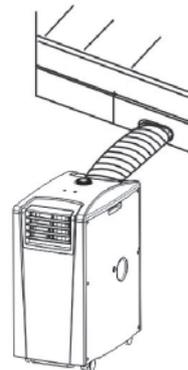
Расстояние от кондиционера до стен и других предметов должно быть не менее 55 см. Запрещается использовать кондиционер в помещениях с высокой влажностью (прачечных, ванных комнатах и т.п.). При установке прибора обеспечьте свободный доступ к розетке сети электропитания. Электромонтаж кондиционера следует выполнять в соответствии с Правилами устройства электроустановок (ПУЭ) и местными нормативными документами.
