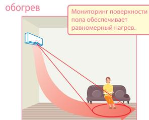
Теплый воздух поднимается к потолку, и кондиционер с обычным датчиком может отключить нагрев до достижения целевой температуры в нижней зоне помещения. Датчик **I SEE** в моделях серии FD контролирует температуру поверхности пола, и кондиционер направляет теплый воздух в нижнюю зону при недостаточном ее нагреве.
